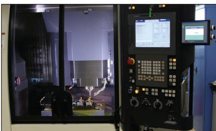
用于模具和设备制造的高速及高精度铣床
