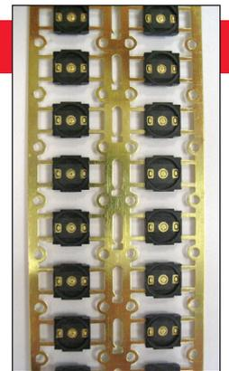
C&K 内部设计和制作的精密金属冲压与重叠注塑模具
