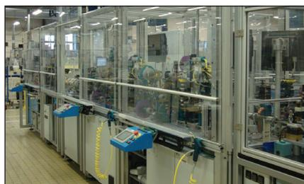
由 C&K 设计和制造的高速自动开关组装机
